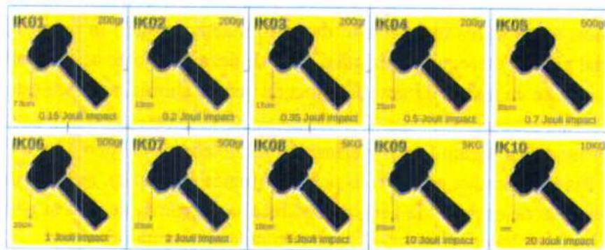
Figura. 6.2 - Gradele de protecție IK
